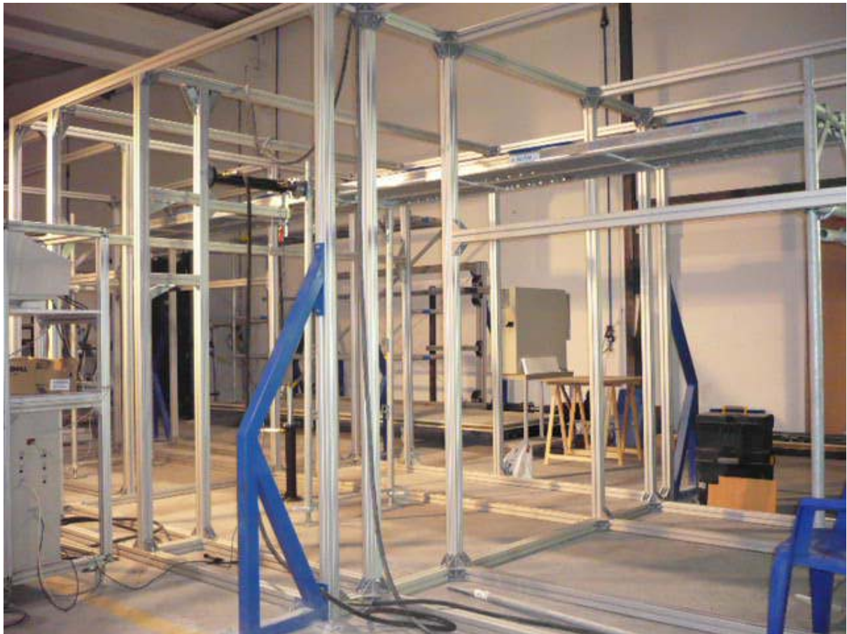
Montaje del ensayo de rigidez
