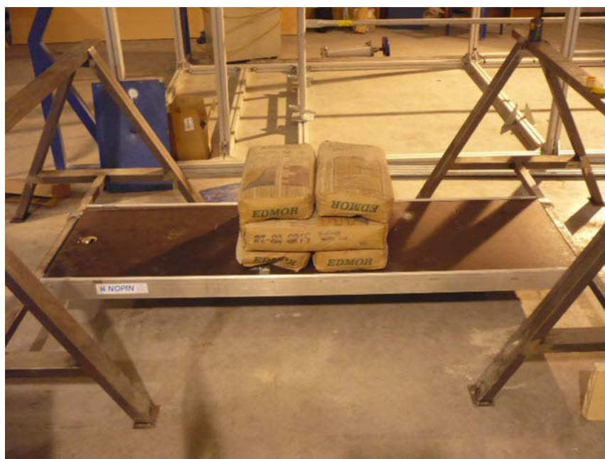
Carga concentrada de la clase 3 para 500 x 500 mm.
