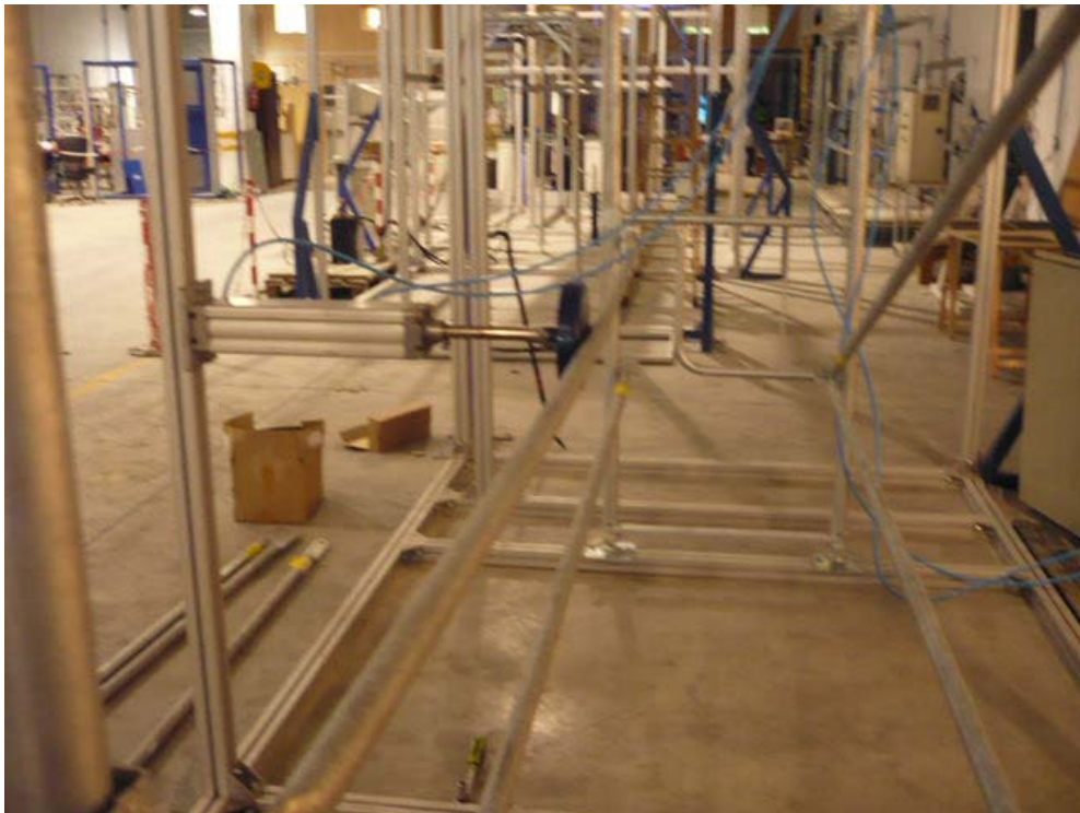
Aplicación de la carga horizontal
