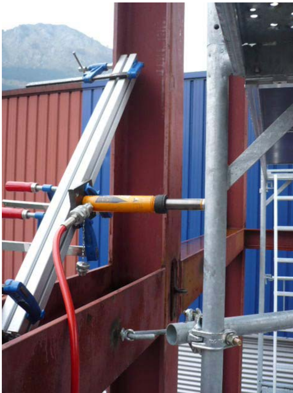
Detalle de aplicación de fuerza transversal al andamio (mediante cilindro hidráulico)
