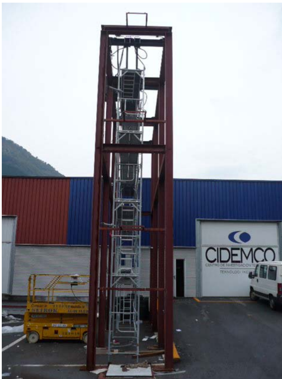
Montaje para ensayo global (vista lateral)
