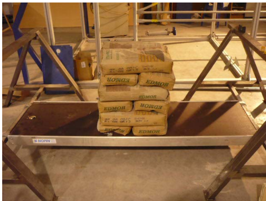
Carga concentrada de la clase 6 para 500 x 500 mm.
