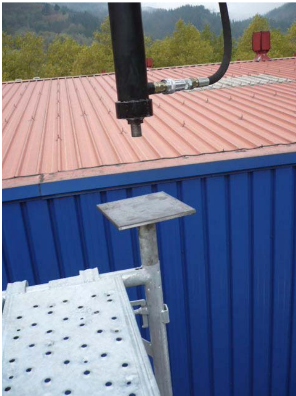
Detalle de aplicación de fuerzas verticales (cilindros hidráulicos)
