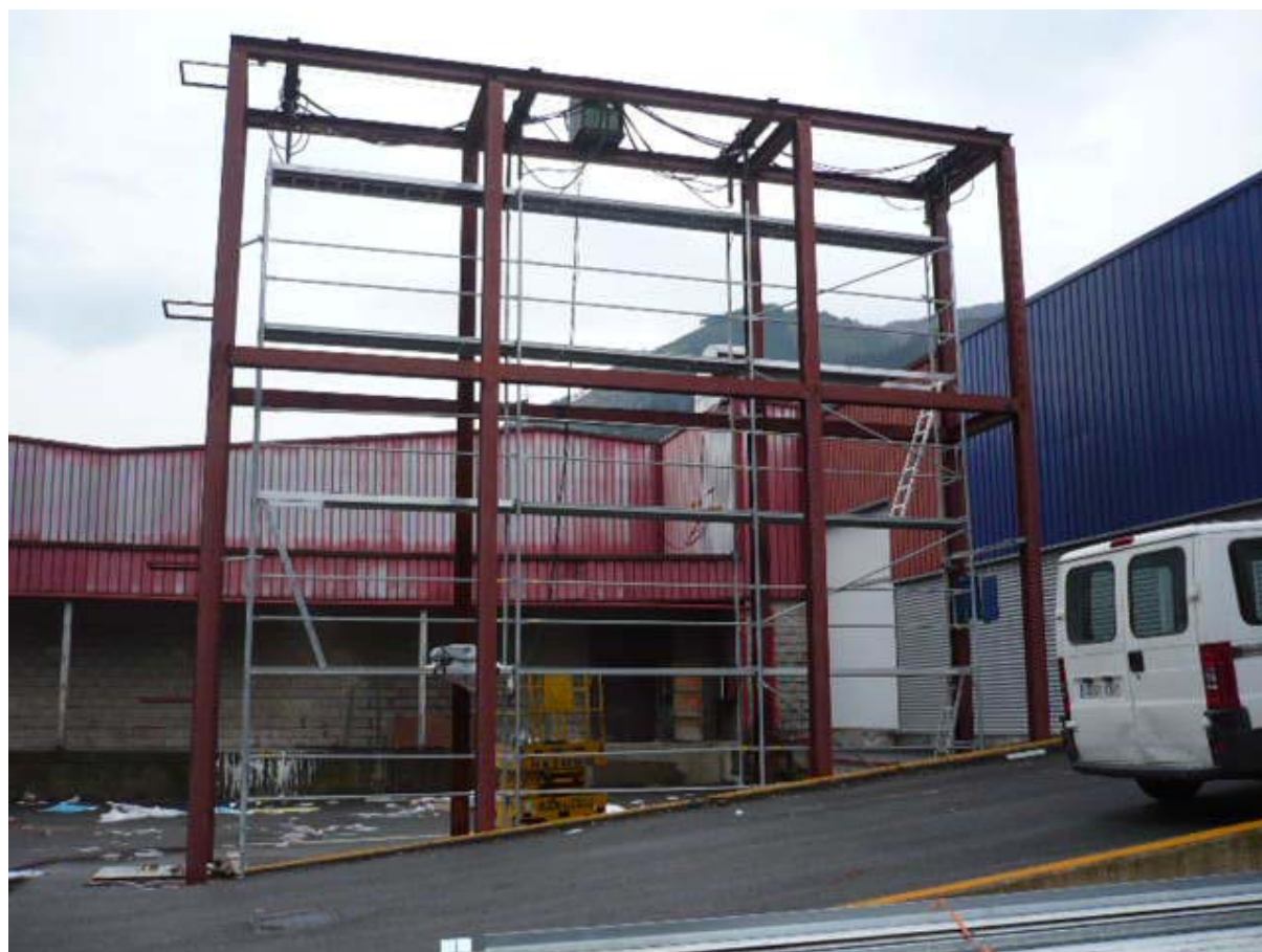
Montaje para ensayo global (vista frontal)
