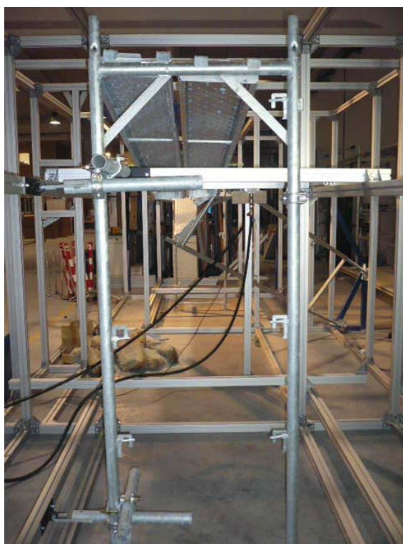
Detalle del amarre del andamio en 7 puntos
