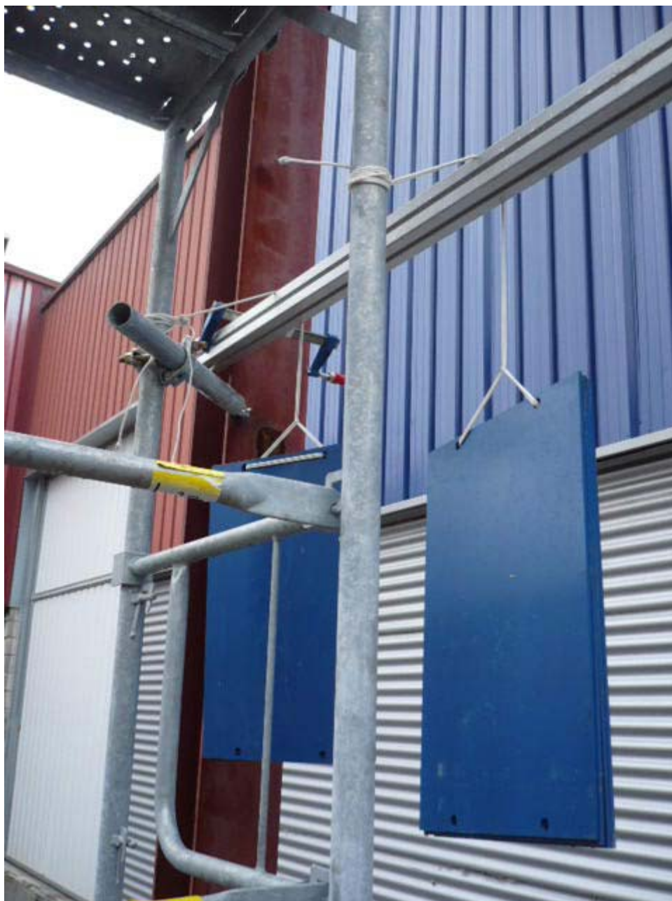
Detalle de aplicación de fuerzas paralelas al andamio (mediante pesos)
