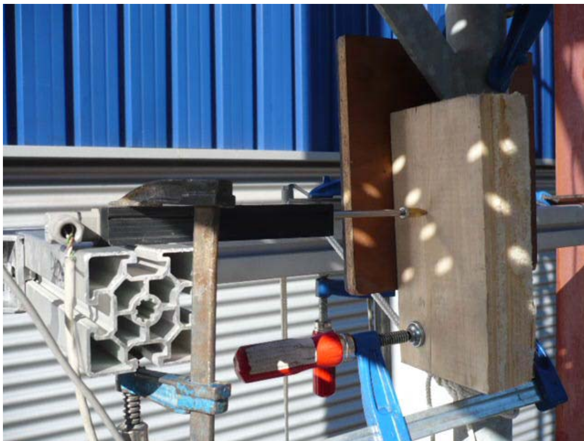
Detalle de palpadores (medición de desplazamientos)
